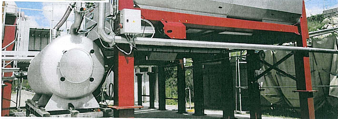
Le système Inertys consiste à remplir d'azote le pressoir à cuve étanche, une fois qu'il est chargé en raisin, via une maie hermétique de réception des jus. À mesure que la membrane du pressoir écrase le raisin (cycle de pressurage), l'azote est récupéré dans une réserve souple qui se gonfle.
