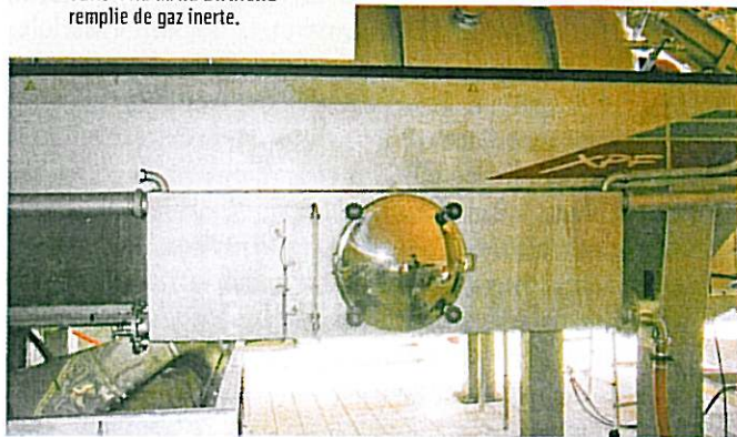
LES JUS SONT DIRIGÉS VERS UNE MAIE ÉTANCHE remplie de gaz inerte.
